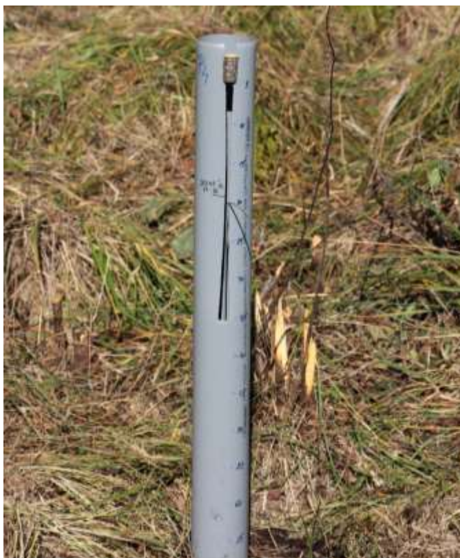
Foto 8- Piezometru montat în situl ROSCI0112 Mlaca Tătarilor
